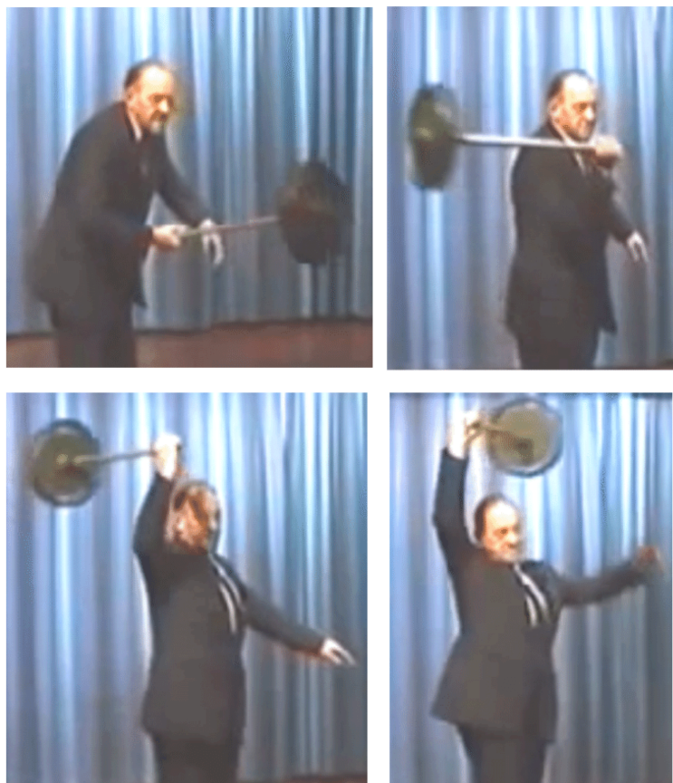
図 6.22 回転コマの持ち上げ実験 片腕では持ち上げられない非常に重い物体は、スピンしていれば、水平に回転させながら軽く持ち上げることができる。
